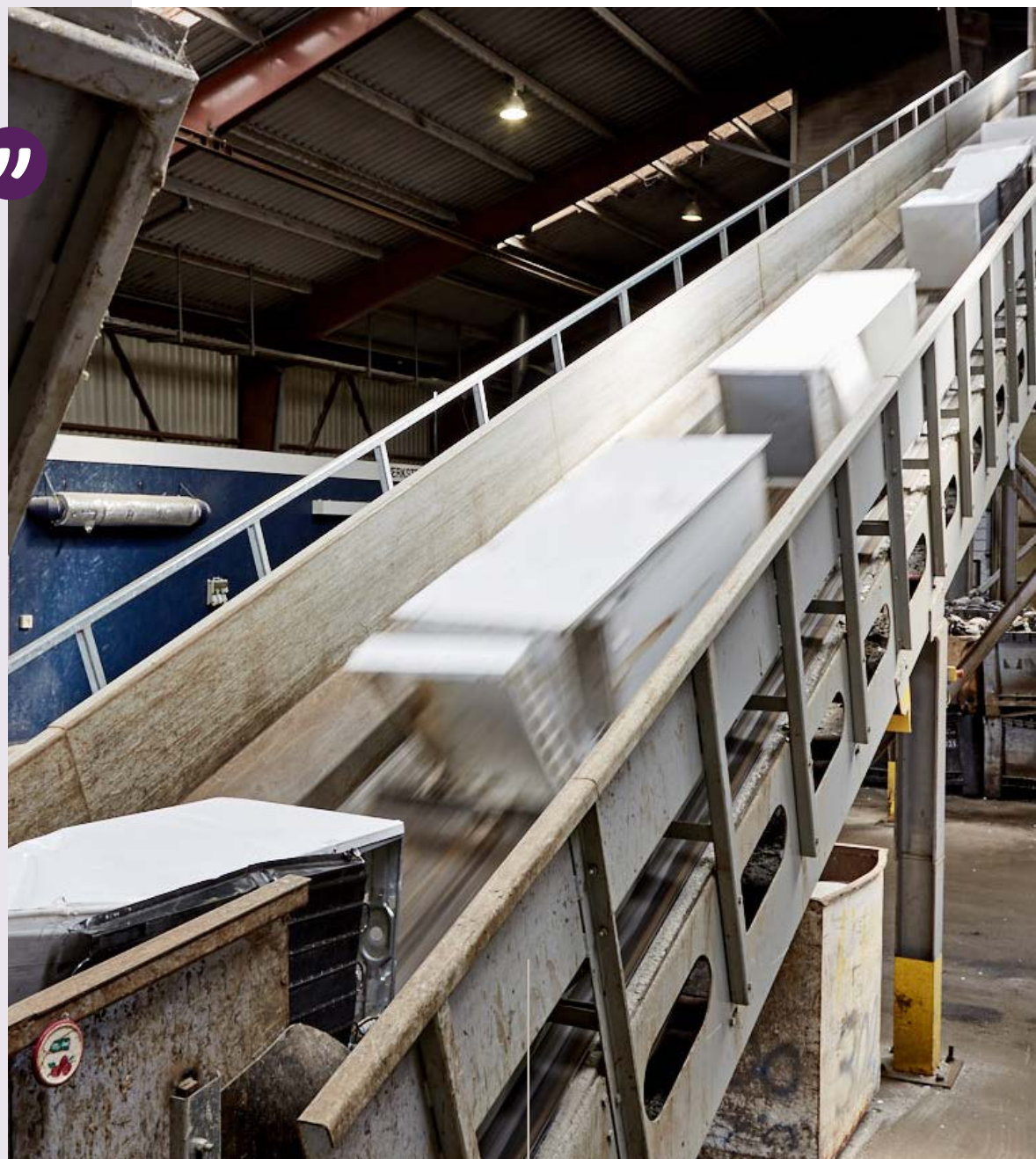
Billede: Fødebånd med køleskabe til shredder
